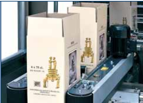
Sigillatura con nastro adesivo Sealing by adhesive tape Fermeture par ruban adhésif
